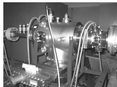
图1 ECR离子源及其低能输运线
