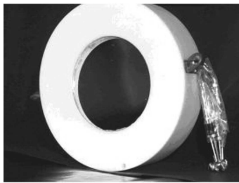
图 4 10 片大面积厚 PIN+11 片 (CF_2)_n 组成的阵列
