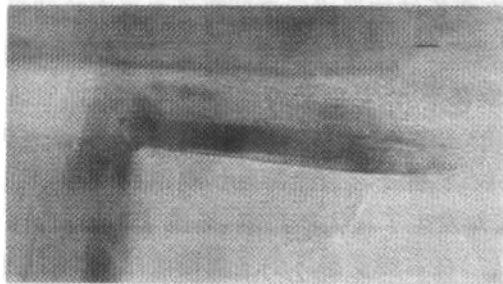
图 1 N_2^+ 离子轰击引起的 BN 片弯折(弯折角约 85^\circ )
