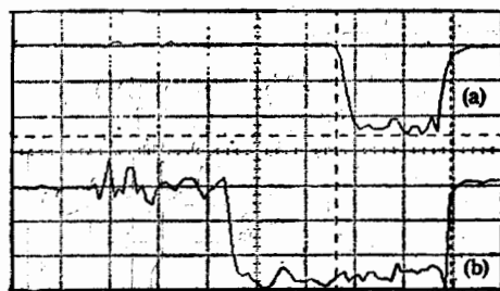
图4 (a) 饱和振荡输出激光讯号(横坐标每格 1\mu\text{s} ); 图5 输出激光讯号前沿(横坐标每格 200\text{ns} ) (b) 注入加速器电流脉冲讯号
